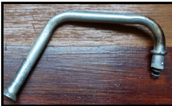
Imagen N°5: Ducto quemador piloto
