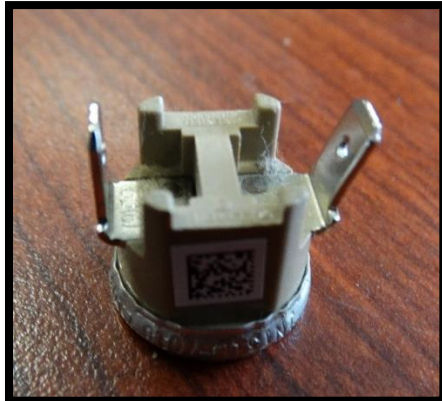
Imagen N°8: Termostato de gases.
