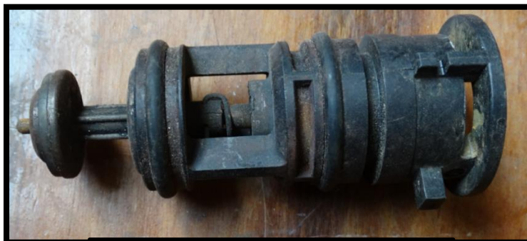
Imagen N°11: Válvula de tres vías
