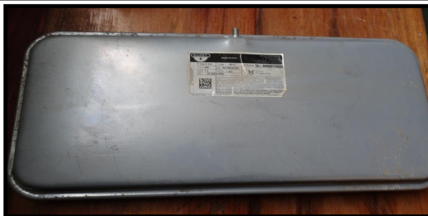
Imagen N°15: Estanque de expansión
