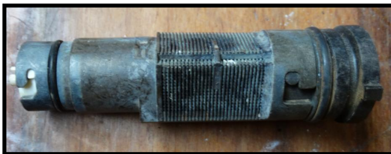
Imagen N°2: Filtro entrada agua potable
