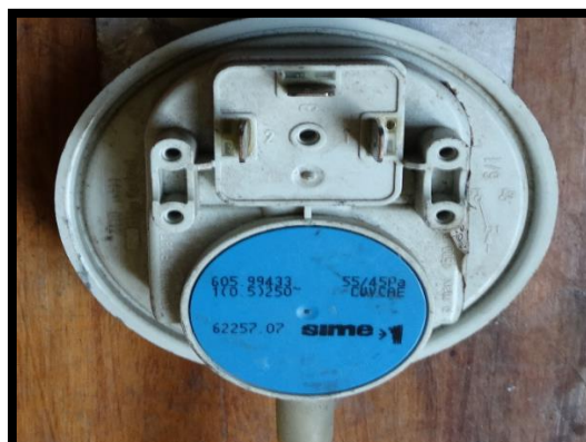
Imagen N°14: Presostato de gases
