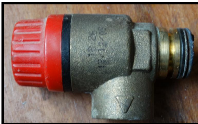
Imagen N°16: Válvula de seguridad.
